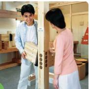
構造材曲げ強度実験 集成材と無垢材の違いを比較!
